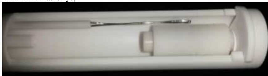
Рис. 2. Контейнер с металлическим порошком установлен в прободержатель dilatометра
