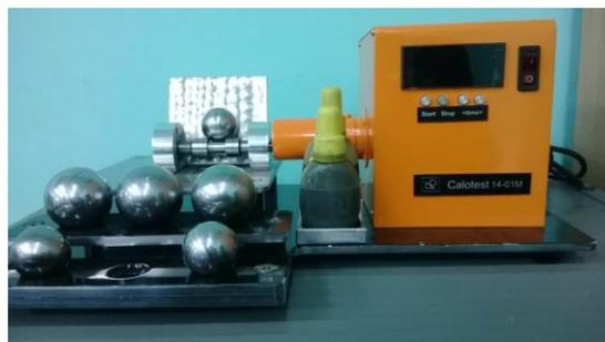
Рисунок 1 Разработанный нами прибор для испытаний материалов и покрытий на микроабразивный износ
